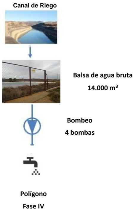
Figura 6. Esquema del funcionamiento del abastecimiento de agua bruta. (Fuente P.D. Abastecimiento)
